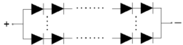
等效电路（4 并 12 串） Equivalent-circuit (4 parallels 12 series)
